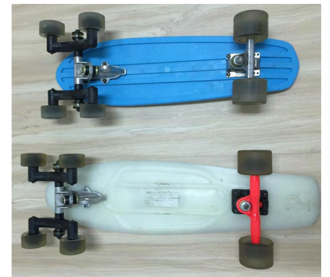
照片為試用八輪滑板零件所組成的測試六輪滑板，使用一般市面塑膠板身
